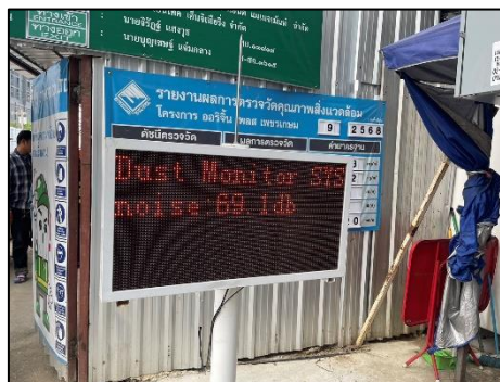
รูปที่ 9 ระบบติดตามตรวจสอบคุณภาพสิ่งแวดล้อมแบบเรียลไทม์ผ่านหน้าจอแสดงผล
